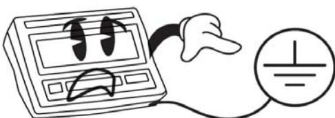
Síťovou šňůru je třeba připojit do zásuvky kde je střídavé síťové napětí 220 až 230V. Zásuvka musí mít ochranný třetí vodič. Do větve zásuvkového obvodu, kde je připojena váha (indikátor), nezapojujte spotřebiče s vyšším příkonem způsobující kolísání napětí. Není-li váha delší dobu používána, doporučuje se odpojit síťovou šňůru ze zásuvky.
