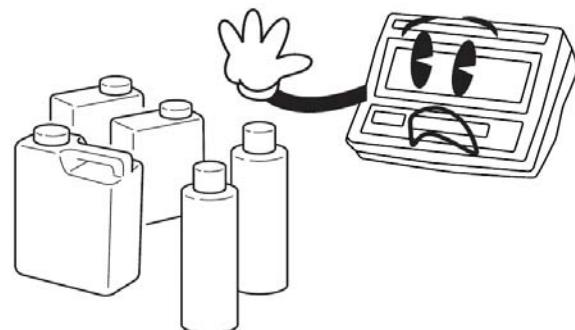
Indikátor CAS DH není určen do mokrého nebo chemicky agresivního prostředí. Čištění, zejména klávesnice a displeje, provádějte pouze vlhkým hadrem bez použití agresivních chemických čisticích prostředků – ty mohou nalepat a zničit klávesnici nebo jiné plastové části.
