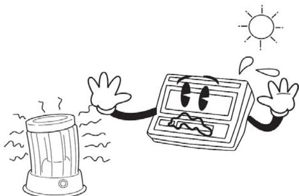
Nevystavujte váhu ani indikátor náhlým změnám teplot ani dlouhodobému přímému působení slunce nebo jiných zdrojů intenzivního tepelného záření.
