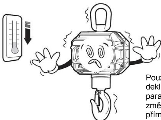
Používejte váhu při pracovních teplotách deklarovaných v tabulce technických parametrů; nevystavujte váhu náhlým změnám teplot ani dlouhodobému přímému působení slunce nebo jiných zdrojů intenzivního tepelného záření.
