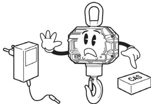
Nepřetěžujte vaši váhu výrazně nad její deklarovanou maximální váživost. Při přetížení více než 120% max. váživosti by mohlo dojít ke zničení snímače zatížení a rovněž vzniká nebezpečí utržení břemene a úrazu.
