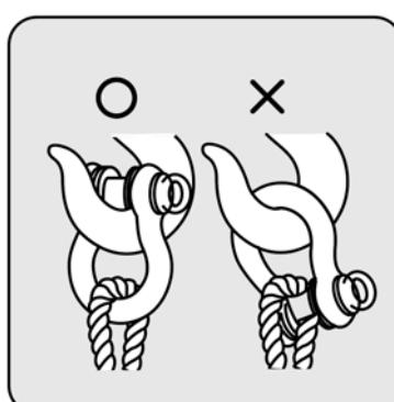
Při zavěšení rozměrného břemene se musí provést zavěšení pomocí třmenu dle obrázku a oba konce závěsného lana nesmějí svírat úhel větší než  $120^{\circ}$
