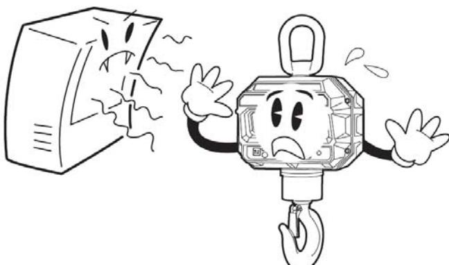
Váhu je nutno provozovat mimo síť vysokonapěťových kabelů, elektromotorů, vysílačů a dalších zařízení, která mohou vytvářet silné elektromagnetické pole.
