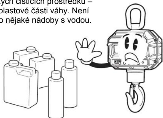
Nevystavujte váhu mechanickým rázům – mohlo by dojít k poškození tenzometrického snímače zatížení. Mějte na paměti, že váha je měřidlo a podle toho je třeba s ní zacházet.
