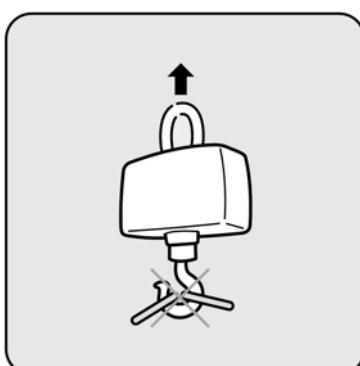
Není přípustné zavěšení rozměrného břemene tak, aby oba konce závěsného lana byly pověšeny přímo na hák – hrozí tak riziko vyklouznutí oka lana z háku
