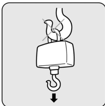
Závěsné oko váhy je nutno zavěsit na vhodný typ jeřábového háku; pokud by byl hák jeřábu příliš velký (předimenzovaný), oko váhy by na něm nebylo volně zavěšeno a nezatěžovalo by hák ve vertikální ose – tento způsob zavěšení rovněž není přípustný
