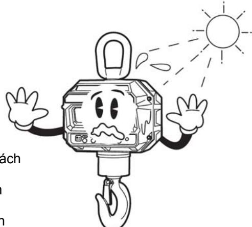
Váha není určena do vyloženě mokrého nebo chemicky agresivního prostředí. Čištění váhy, zejména klávesnice a displeje, provádějte pouze vlhkým hadrem bez použití agresivních chemických čisticích prostředků – ty mohou naleptat a zničit klávesnici nebo jiné plastové části váhy. Není přípustné například umývání váhy ponořením do nějaké nádoby s vodou.
