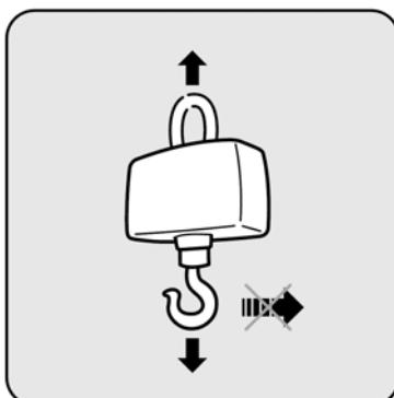
Váha včetně závěsných prvků musí být zatěžována vždy vertikálně (svisle), nikoliv horizontálně (do boku)
