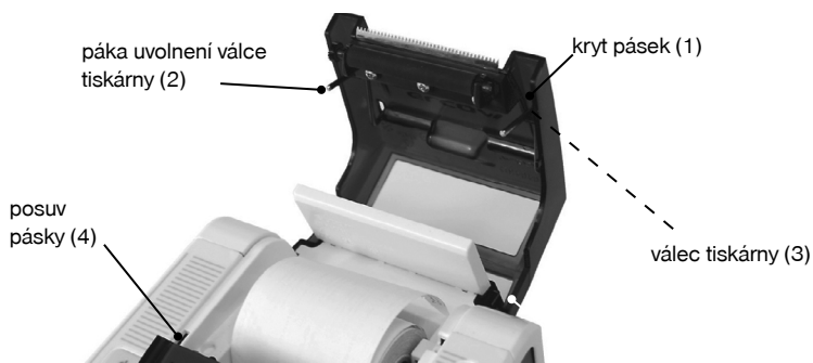
Obrázek 2.6 – Zavedení papírové pásky do tiskárny
