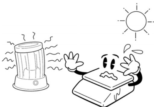
Nevystavujte váhu náhlým změnám teplot ani dlouhodobému přímému působení slunce nebo jiných zdrojů intenzivního tepelného záření. Pokud váhu přemístíte z venkovního prostředí, doporučuje se zapnout váhu 15 až 30 minut před použitím pro důkladnou teplotu.
