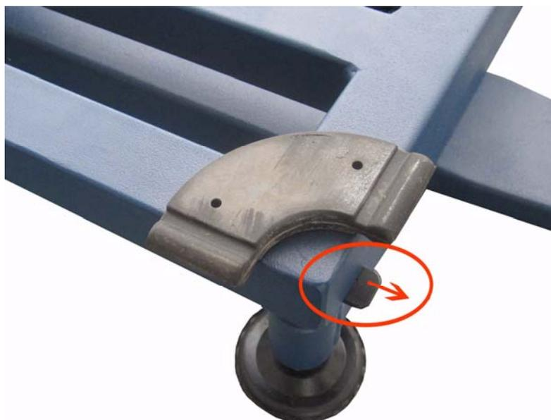
**B. U některých modelů vah je použito aretačního šroubu na spodní straně snímače zatížení**
